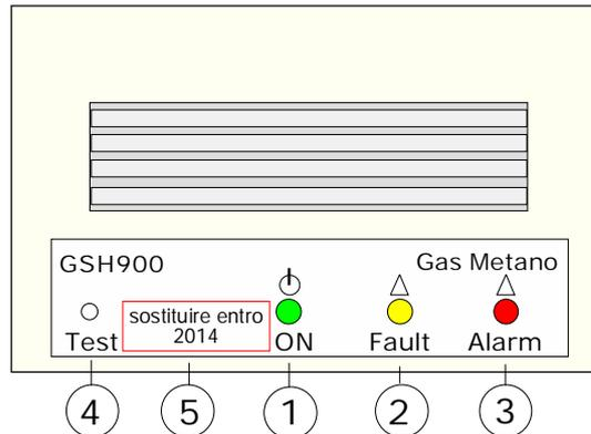
**1) Led di segnalazione di RETE inserita.** Dopo avere immesso tensione, il **GSH900** effettua il controllo dello stato di efficienza del sensore e provvede a portarlo alla temperatura di esercizio. Questa fase dura circa 60 secondi al termine dei quali il rivelatore emetterà un **"BIP"**. Da quel momento è pronto a rilevare.
