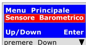
Questo programma serve per attivare il sensore barometrico. Premendo il pulsante "Enter" lo strumento vi chiederà se volete o non volete attivare il controllo della pressione barometrica. Agendo sui pulsanti "Down" o "UP" lo si attiva, o disattiva premendo "Enter" si conferma. Quando è attivato appare la scritta sulla videata principale.
