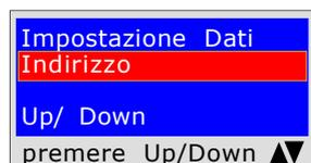
Il programma chiede di inserire **l'indirizzo dello stabile** in cui si esegue la prova, tenendo presente che si hanno a disposizione 20 caratteri totali. Per inserire i caratteri premere i pulsanti appropriati (come quando si invia un SMS).
