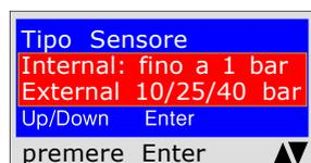
Il programma chiede di selezionare il tipo di sensore, il sensore deve essere selezionato a seconda del tipo di pressione da misurare.
