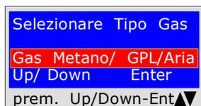
Il programma chiede con quale tipo di gas si deve procedere alla prova: Gas Metano e/o Gas GPL, oppure Aria.
