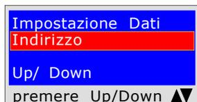
Il programma chiede di inserire **l'indirizzo dello stabile** in cui si esegue la prova, tenendo presente che si hanno a disposizione 20 caratteri totali. Per inserire i caratteri premere i pulsanti appropriati (come quando si invia un SMS). Per andare avanti/indietro usare i tasti di navigazione, per lo spazio bianco usare il tasto con il numero 1.
