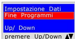
Il programma chiede se si vuole terminare l'inserimento dei dati. Premere **Up/Down**, se si vuole rileggere i dati inseriti. Per modificare eventuali dati usare i tasti di navigazione, e correggere. Premere **ENTER** per terminare e uscire dal programma.
