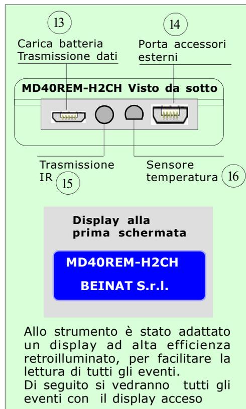
Allo strumento è stato adattato un display ad alta efficienza retroilluminato, per facilitare la lettura di tutti gli eventi. Di seguito si vedranno tutti gli eventi con il display acceso
