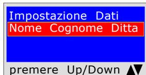
Il programma chiede di inserire **l'ubicazione dell'impianto** in cui si esegue la prova, tenendo presente che si hanno a disposizione 20 caratteri totali. Per inserire i caratteri premere i pulsanti appropriati (come quando si invia un SMS). Per andare avanti/indietro usare i tasti di navigazione, per lo spazio bianco usare il tasto con il numero 1.
