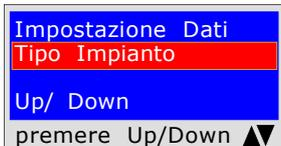
Il programma chiede di inserire **il tipo di impianto**, se di uso civile, di riscaldamento, di uso industriale, o quant'altro tenendo presente che si hanno a disposizione 20 caratteri totali.
