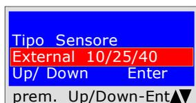
Il programma chiede quale tipo di sensore si deve usare: 10/25/40 bar Scegliere premendo-/Down e Premere **ENTER** per confermare
