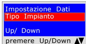
Il programma chiede di inserire **il tipo di impianto**, se di uso civile, di riscaldamento, di uso industriale, o quant'altro tenendo presente che si hanno a disposizione 20 caratteri totali. Per inserire i caratteri premere i pulsanti appropriati (come quando si invia un SMS). Per andare avanti/indietro usare i tasti di navigazione, per lo spazio bianco usare il tasto con il numero 1.
