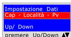
Il programma chiede di inserire **il Cap la Città e la Provincia** dello **stabile** in cui si esegue la prova tenendo presente che si hanno a disposizione 20 caratteri totali.
