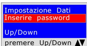
Per tutelare i propri dati anagrafici prima di accedere alla programmazione bisogna **inserire la Password (\*\*\*)** Una volta inserita premere **Up/Down**. Se si sbaglia lo strumento esce dalla configurazione.
