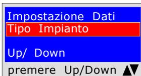
Il programma chiede di inserire **il tipo di impianto**, se di uso civile, di riscaldamento, di uso industriale, o quant'altro tenendo presente che si hanno a disposizione 20 caratteri totali.
