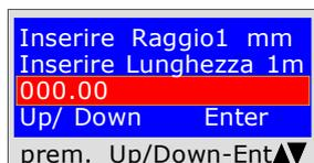
Si chiede di inserire le misure di diametro e di lunghezza per calcolare il volume.
